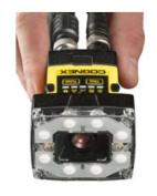
Считыватель кодов с функцией верификации 2D-кода
