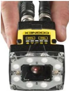
Считыватель-верификатор 2D кодов **с функцией верификации кода по стандарту ГОСТ Р ИСО/МЭК 15415-2012**
